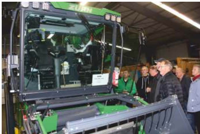
Alles andere als Serienfertigung: Jeder Parzellen-Mähdrescher ist eine Einzelanfertigung nach den Wünschen des Kunden. Bild: G. Bernauer
