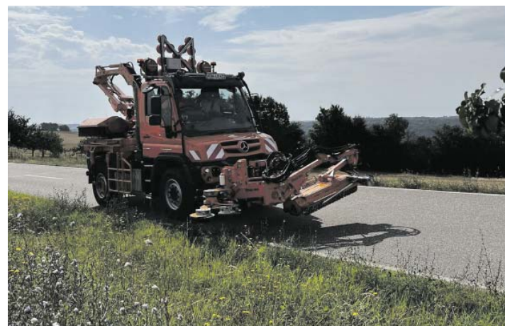
Der neue Unimog der Straßenmeisterei des Hohenlohekreises in Künzelsau ist mit Mähgeräten zum Ausmähen von Leitpfosten (vorne) und zum Mähen von Böschungsflächen (hinten) ausgestattet. Foto: LRA HOK
